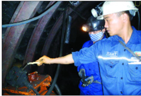
Cán bộ giám sát an toàn của Công ty Than Mạo Khê kiểm tra khe hở phòng nổ của thiết bị trong lò tại Phân xưởng KT8.
